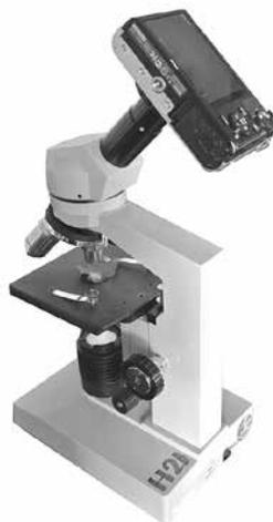
定すると、生きたミジンコなど動きのある観察対象でもブレを少なくして撮影できる。カメラ側に動画撮影機能があれば、写真だけでなく映像も高画質で撮影可能。撮影データはカメラのプレビュー機能で即確認できるほか、多くの一眼カメラが外部出力端子（HDMI）を持つので、プロジェクタやモニターなどに出力して大人数で見せ合うことも可能である。
