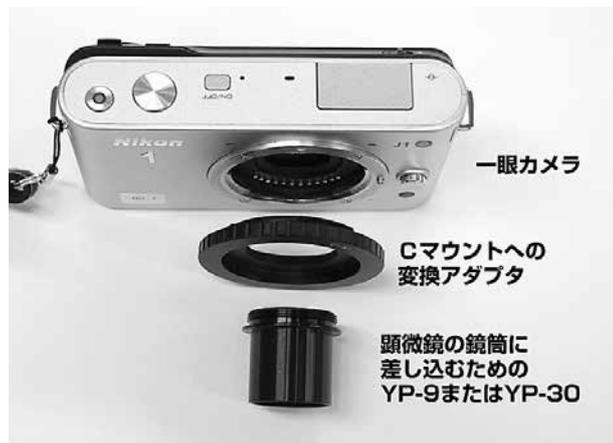
写真1: 顕微鏡カメラの部品(左)と顕微鏡に接続した様子(右)
