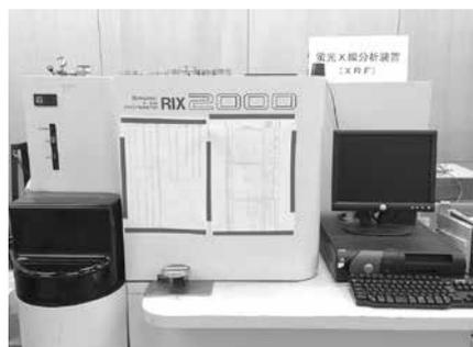
写真4: 蛍光X線分析装置(左手前が試料室)
